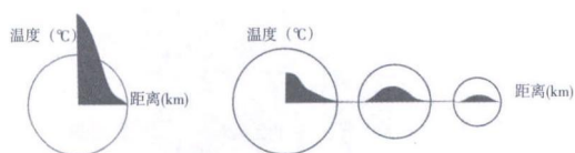
图4 单中心与多中心空间结构下的热岛效应比较示意 Fig.4 Heat island schemes of mono- and polycentric cities
